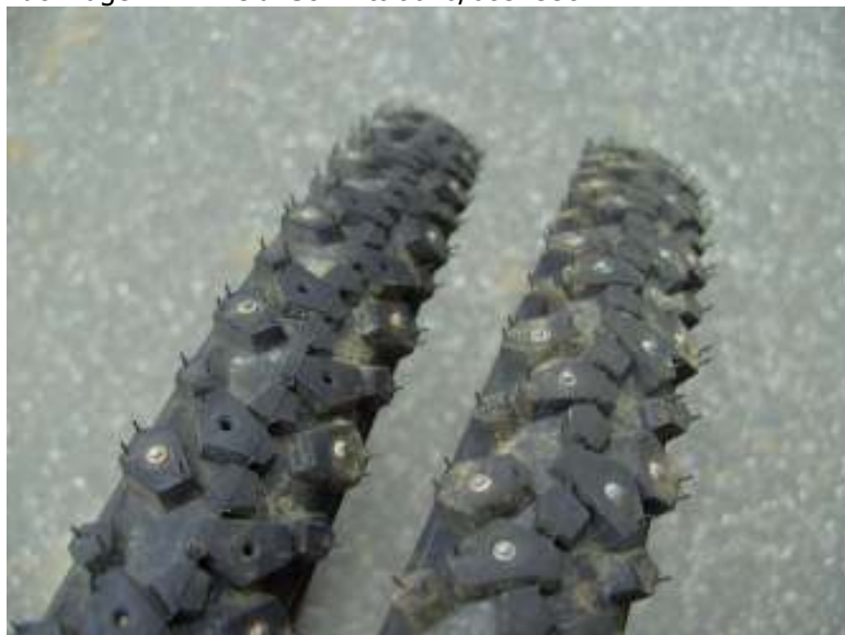
Spikereifen von Conti links zweireihig, rechts vierreihig
